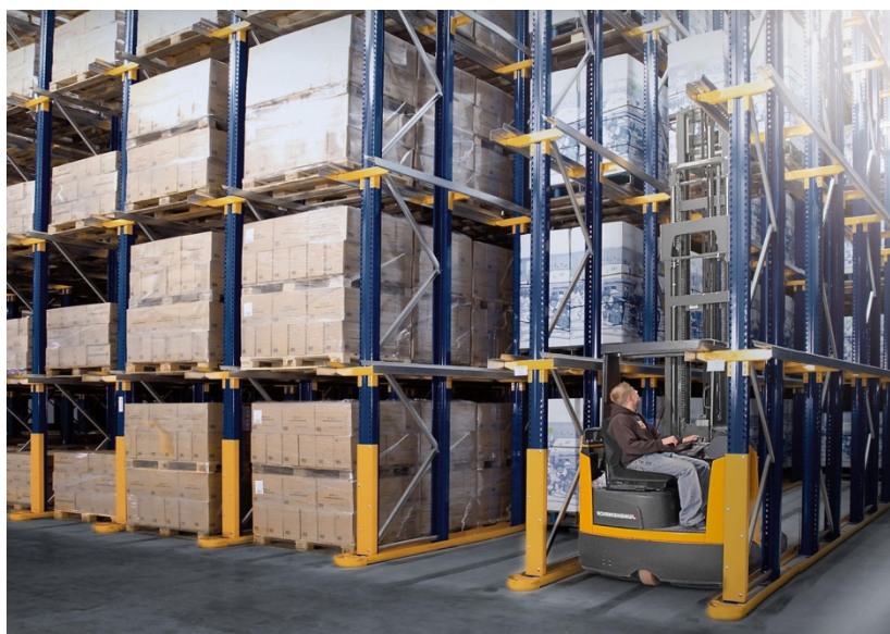
Εικόνα 4: Σύστημα Αποθήκευσης Drive In – Through Πηγή: https://www.jungheinrich.gr/
