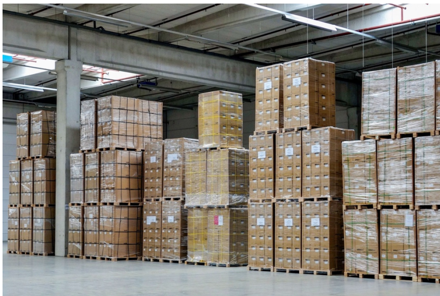
Εικόνα 1: Σύστημα Αποθήκευσης Block Stacking
