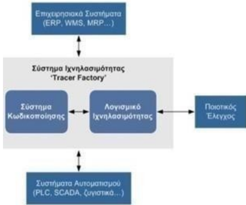
Εικόνα 17: Σύστημα Trace Factory
