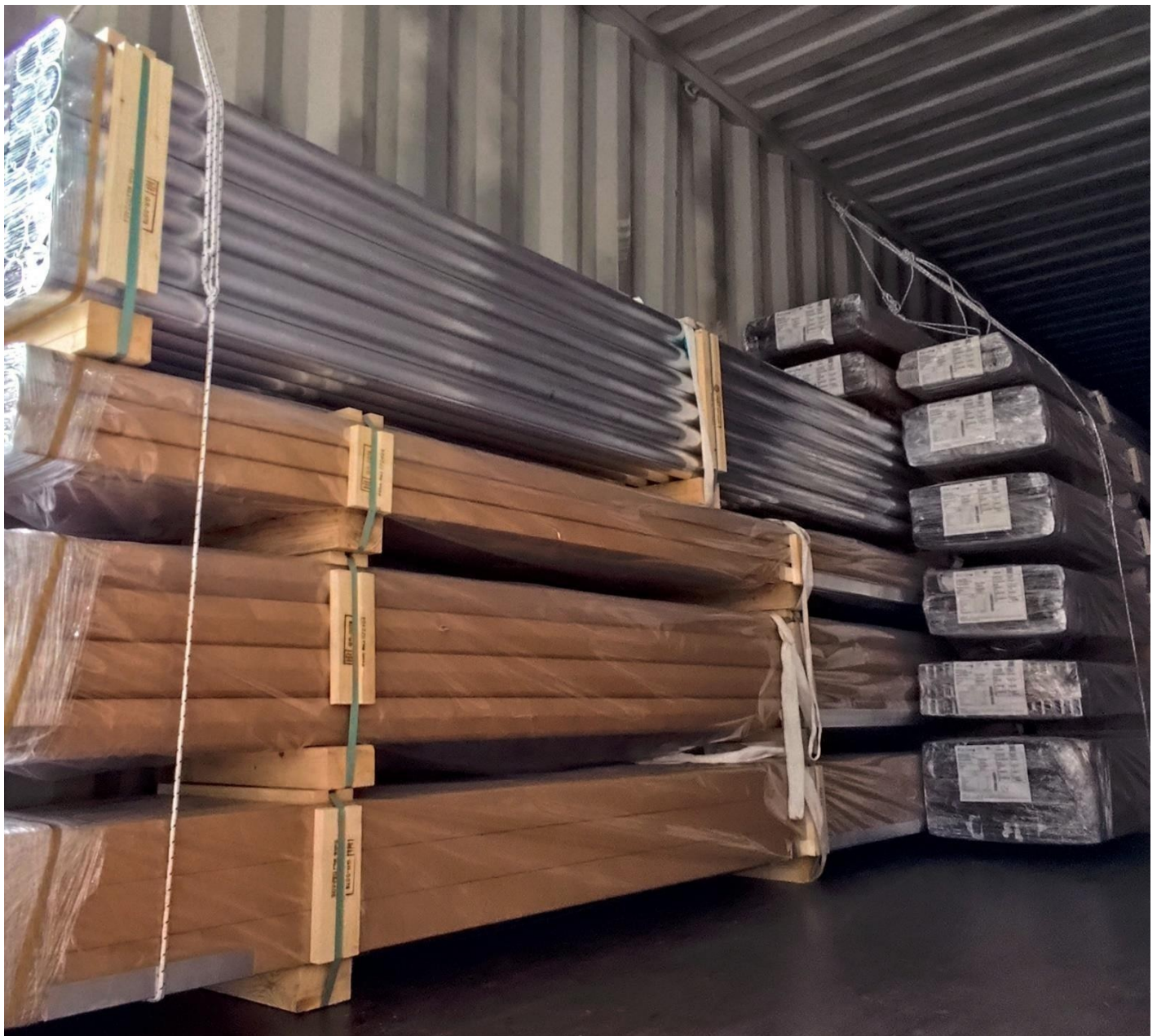
Εικόνα 63: Εσωτερικό δέσιμο δεμάτων
