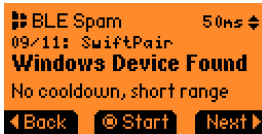
Εικόνα 6.2: Πραγματοποίηση επίθεσης BLESpam μέσω του FlipperZero, με αποστολή πακέτων ανά 50 ms.
