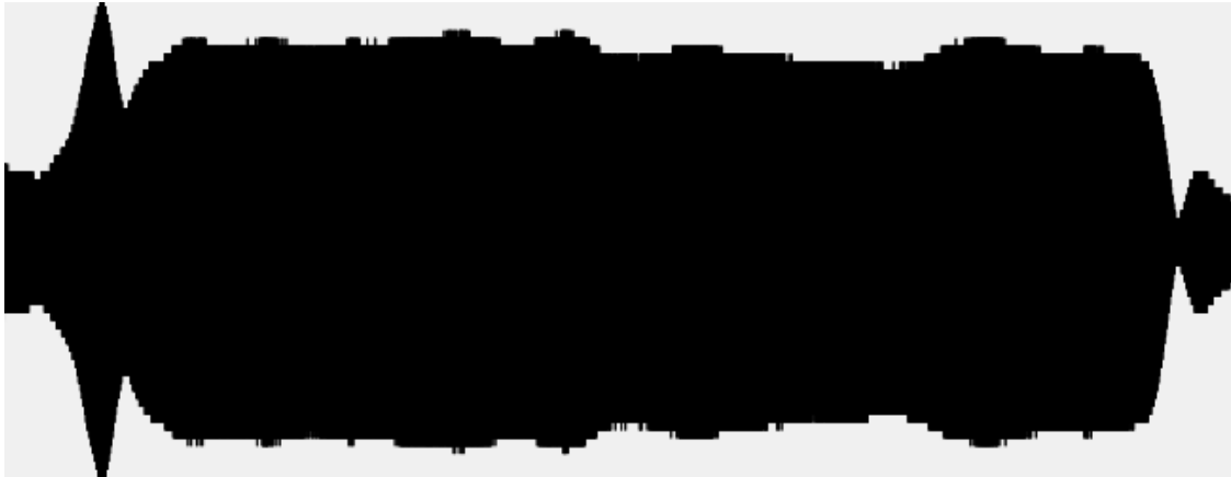
Εικόνα 4.16: Ενδεικτική κυματομορφή, καθώς το FlipperZero παρεμβάλλει την συχνότητα των 433.92 MHz.
