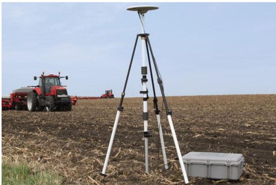
Εικόνα 2: Σταθερός επίγειος σταθμός RTK GPS
