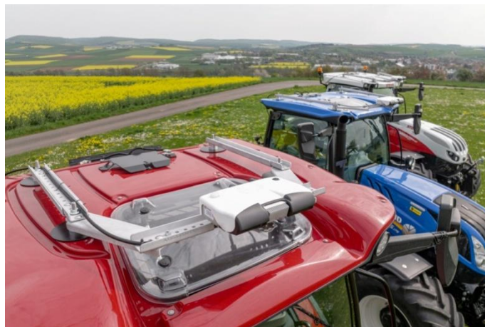
Εικόνα 7: Τροποποιημένοι ελκυστήρες με εγκατεστημένο το σύστημα μηχανικής όρασης της εταιρίας 'Augmenta'
