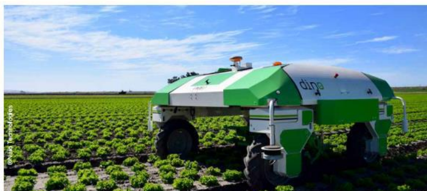
Εικόνα 8: Ρομποτική πλατφόρμα 'Dino', για μηχανικό εντοπισμό και αφαίρεση ζιζανίων
