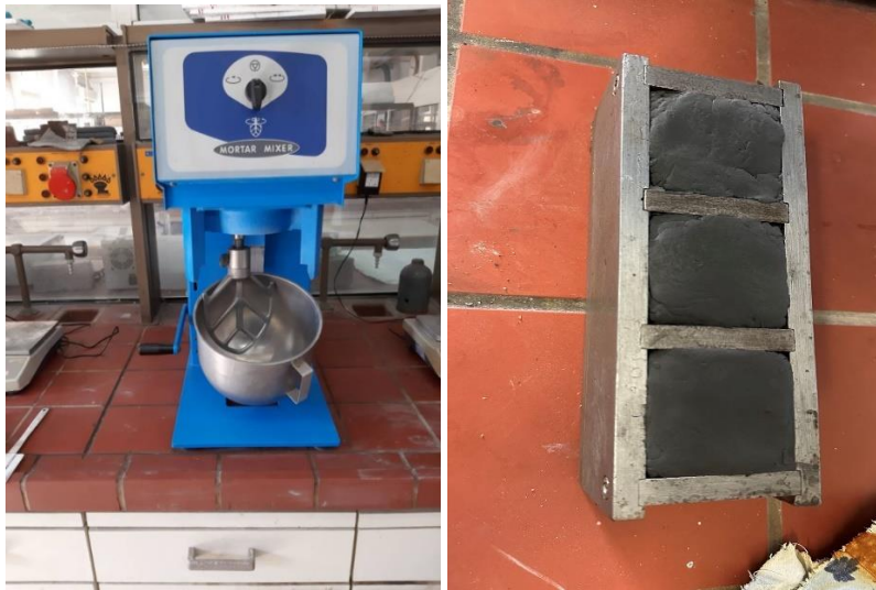
Εικόνα 34 Αριστερή φωτογραφία: Μηχάνημα γεωπολυμερισμού υλικών και Δεξιά φωτογραφία μήτρα των γεωπολυμερών.
