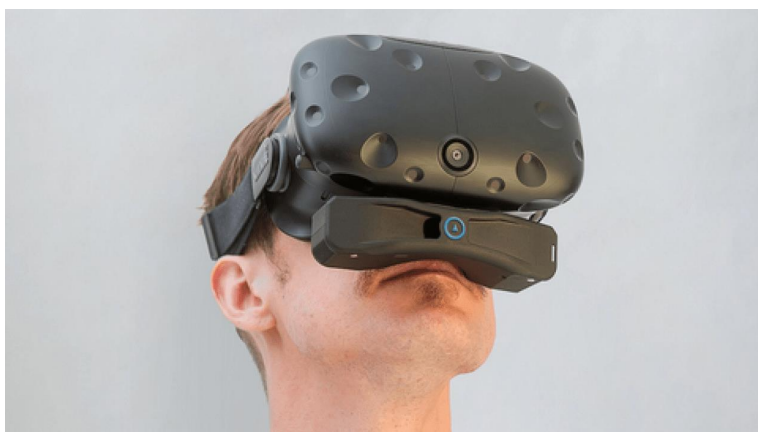
Εικόνα 54: Εξοπλισμός για την όσφρηση του χρήστη.
