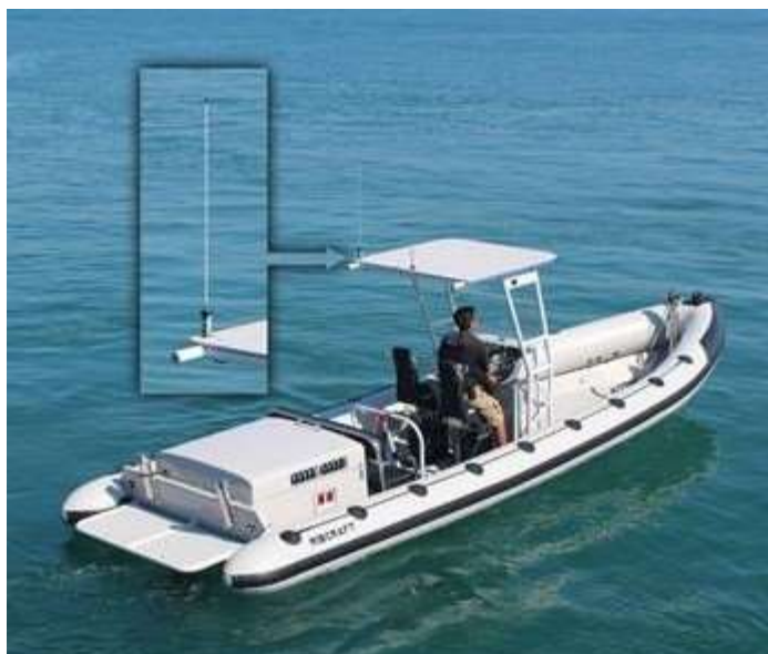
ΕΙΚΟΝΑ 2.4 Κεραία VHF σε σκάφος ( https://stock.adobe.com/gr_en/search?k=vhf )
