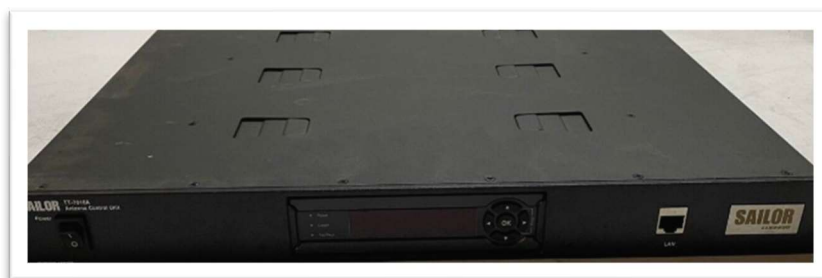
ΕΙΚΟΝΑ 3.13 Μονάδα ελέγχου κεραίας τύπου SAILOR (Προσωπική φωτογραφία αρχείου)
