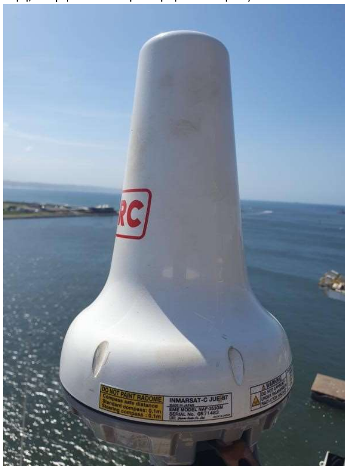
ΕΙΚΟΝΑ 3.8 Κεραία JRC JUE-87 (INMARSAT-C) (Προσωπική φωτογραφία αρχείου)
