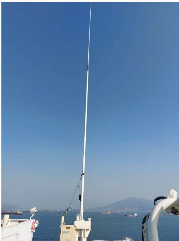
ΕΙΚΟΝΑ 2.5 Κεραία MF/HF σε σκάφος (Προσωπική φωτογραφία αρχείου)
