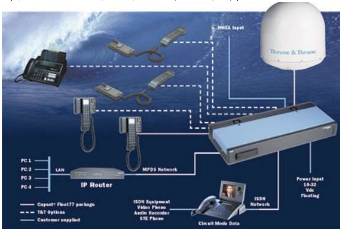
ΕΙΚΟΝΑ 3.7 Ανάλυση τοπολογίας INMARSAT FLEET 77 συστήματος ( https://www.psicompany.com/jrc-jue-410f-f77-fleet-broadband-inmarsat )
