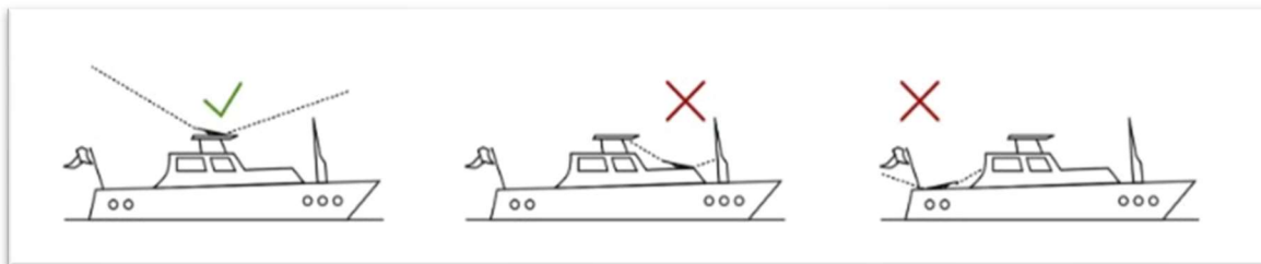
ΕΙΚΟΝΑ 4.3 Σωστή θέση εγκατάστασης κεραίας Starlink σε πλοίο ( https://www.starlink.com )
