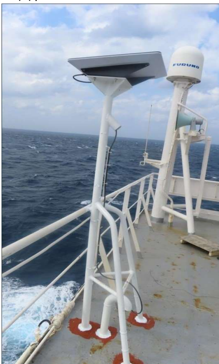
ΕΙΚΟΝΑ 4.4 Κεραία Starlink στην κόντρα γέφυρα πλοίου τύπου Bulker (Προσωπική φωτογραφία αρχείου)
