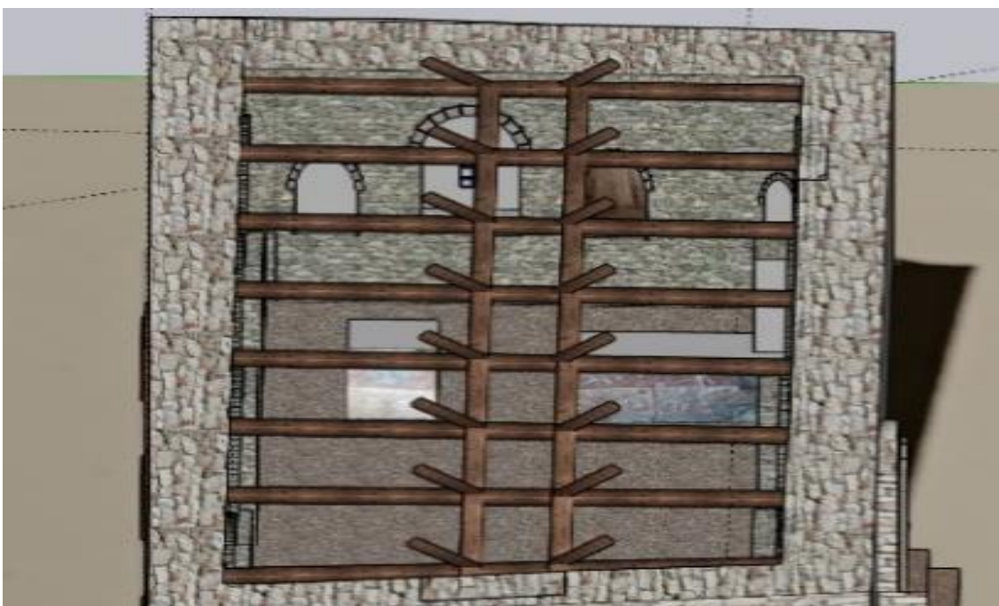
Εικόνα 6.13: Τοποθέτηση ξύλινων δοκαριών.
