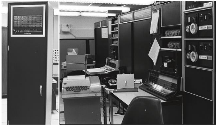
Εικόνα 2 - Μηχανές τηλεειδοποίησης TENEX και DEC-KA10 που χρησιμοποιούνταν για την ανάπτυξη του TENEX (Walden & Nickerson, 2011)
