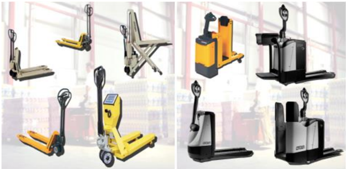
Εικόνα 2.26: Είδη παλετοφόρων χωρίς ιστό ανύψωσης (ηλεκτρικά-μηχανικά)
