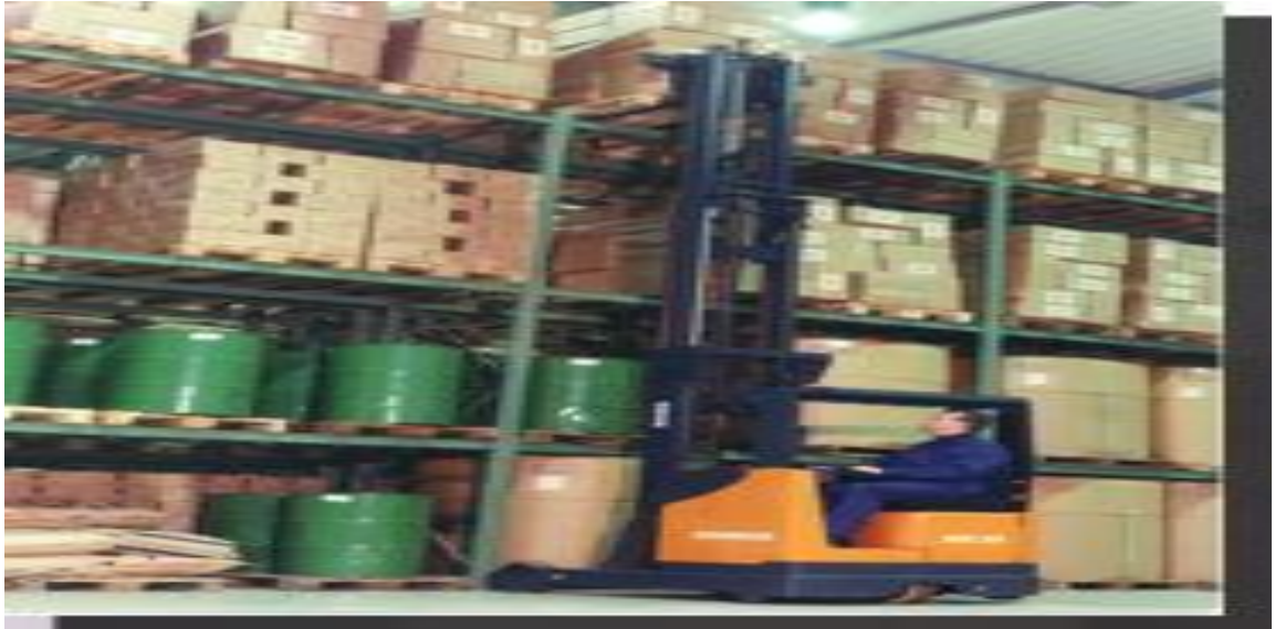
Εικόνα 2.23: Περονοφόρο τύπου Reach Truck
