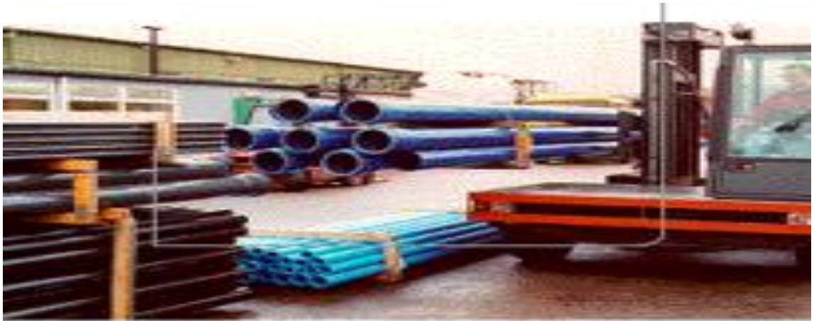
Εικόνα 2.20: Περονοφόρο πλάγιας φόρτωσης
