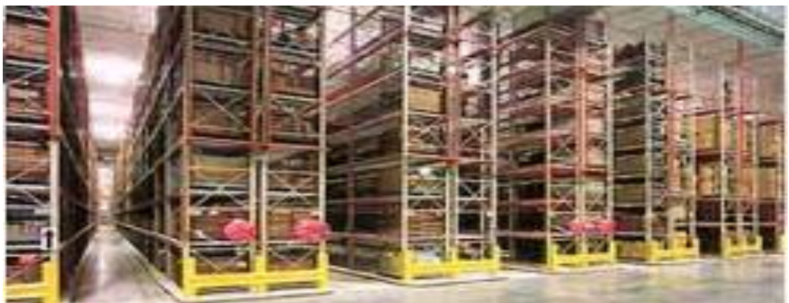
Εικόνα 2.21: Παλετόραφα τύπου «back to back»
