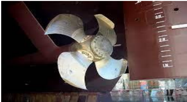
Εικόνα 5: Kappel type propeller (Giulio Gennaro, Σεπτέμβριος 2012)
