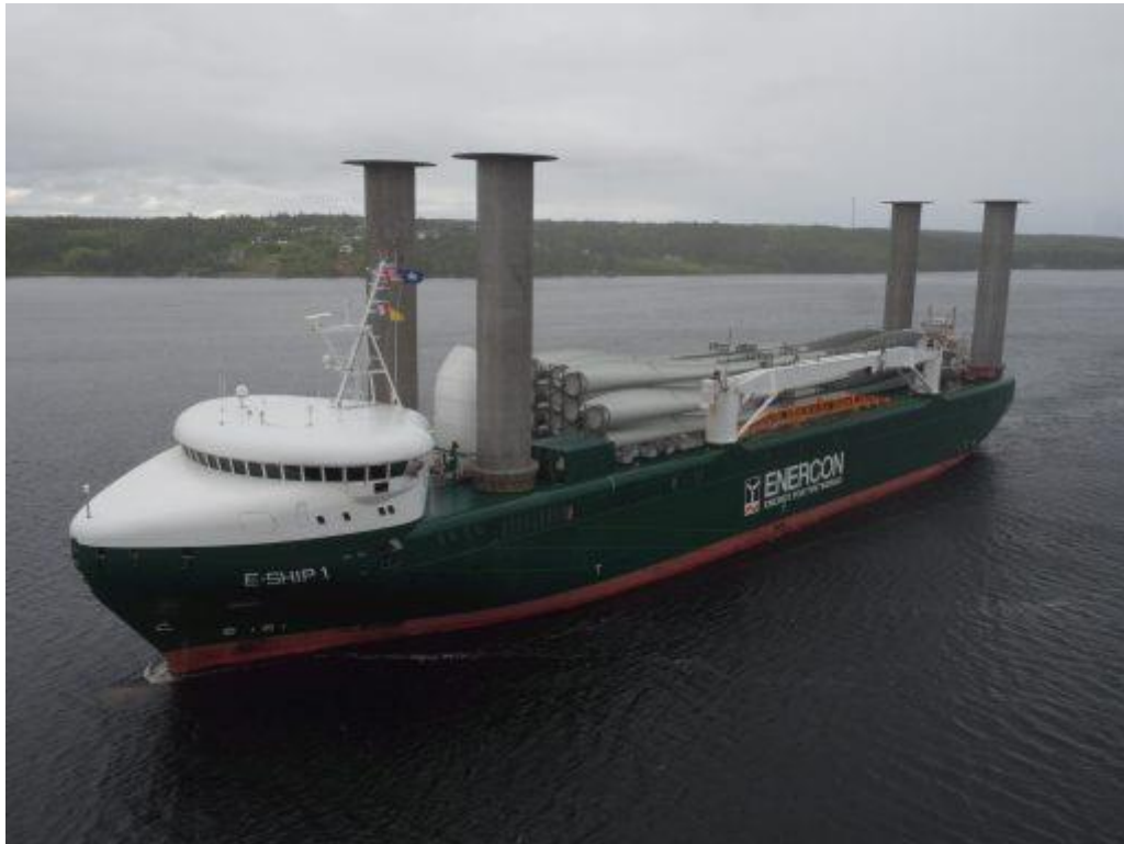
Εικόνα 10: Flettner rotors (IWSA)
