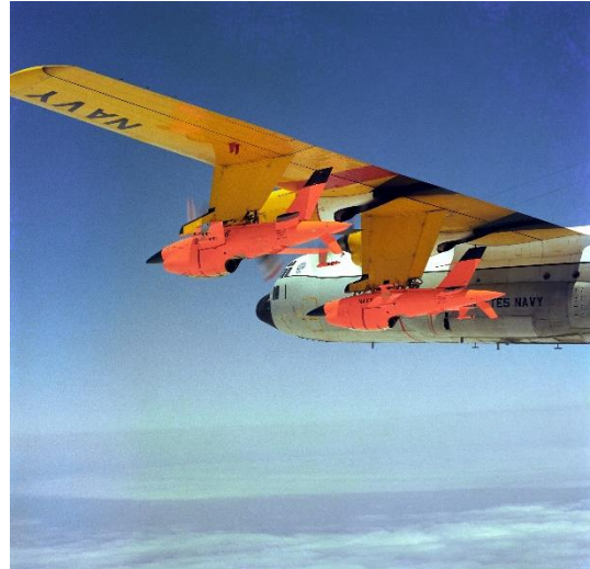
Εικόνα 8: Το Lightning Bug αναρτημένο σε αεροσκάφος C130- Πηγή- https://en.m.wikipedia.org/wiki/File:DC130_mounted_Firebees_DN-SC-85-06043
