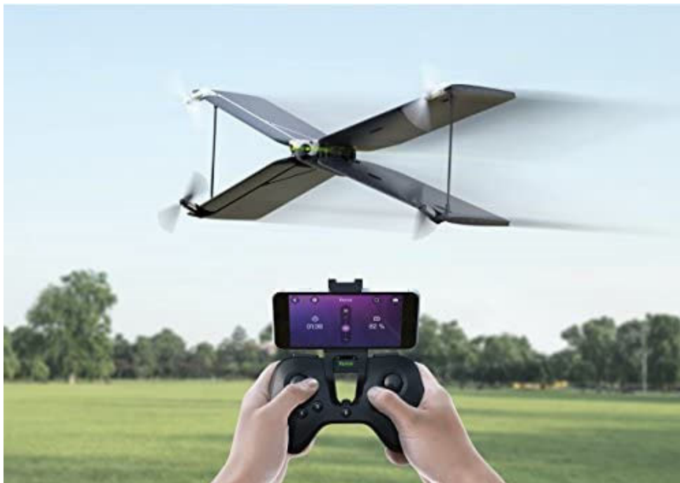
Εικόνα 1: Το Parrot Swing, υβριδικό ΣμηΕΑ, με δυνατότητα πτήσης με ρόtores και σταθερή πτέρυγα
