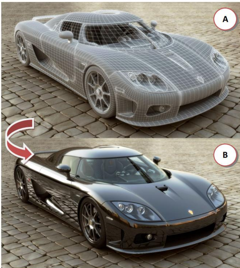
Εικ.6 Απεικόνιση α) τρισδιάστατο μοντέλο β) μοντέλο το οποίο έχει υποστεί rendering.
