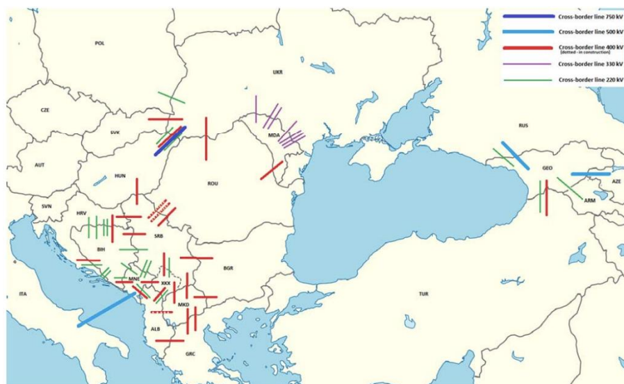
Εικόνα 24 - Υφιστάμενες διασυνοριακές γραμμές στα συμβαλλόμενα μέρη της EnC (προς άλλα CP και κράτη-μέλη της ΕΕ)
