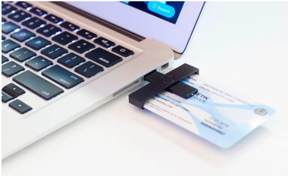
Εικόνα 13: Η ηλεκτρονική ταυτότητα (Digital ID) και η χρήση του αναγνώστη έξυπνων καρτών (smart card reader)
