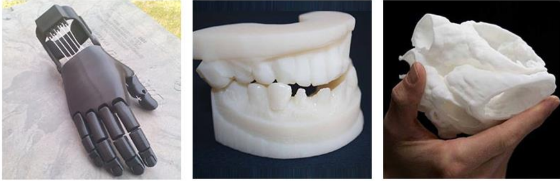
Εικόνα 5.1: Παραδείγματα προσθετικών μελών μέσω 3D Printing τεχνολογίας.
