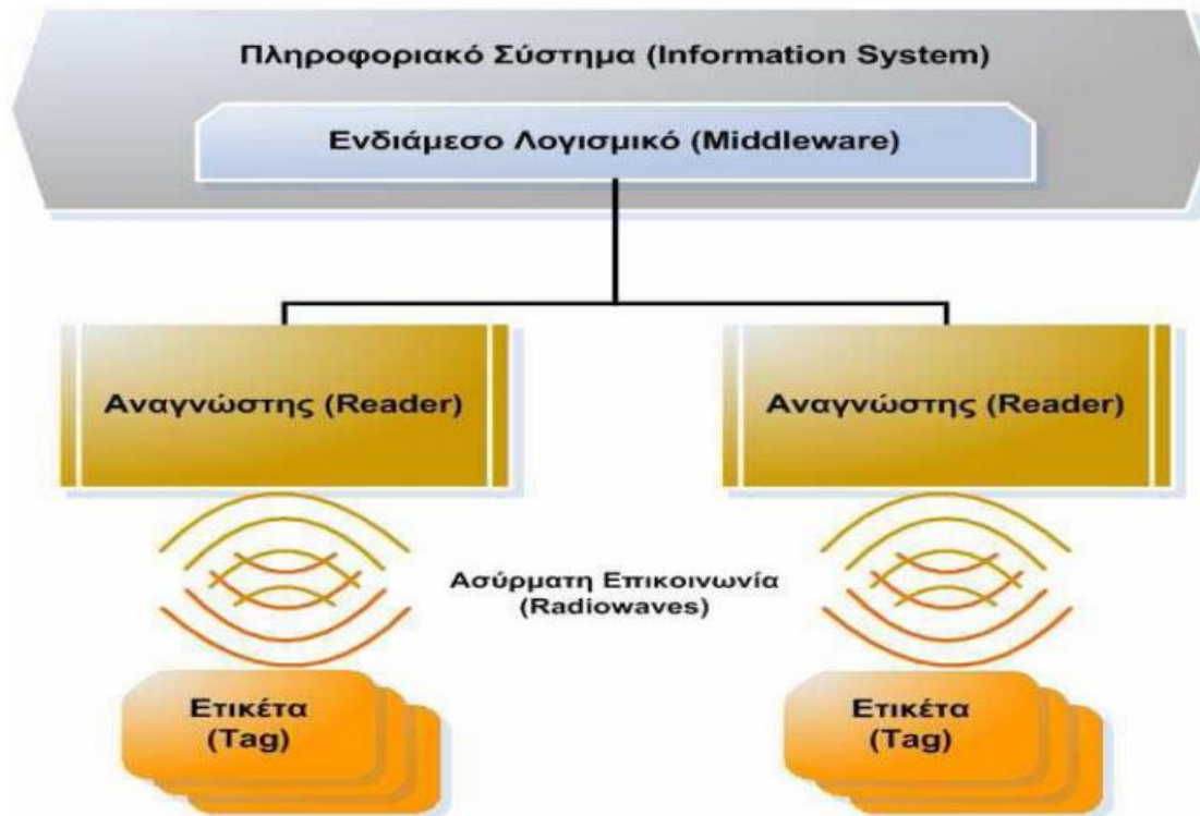
Εικόνα 6: Αρχιτεκτονική συστήματος RFID.
