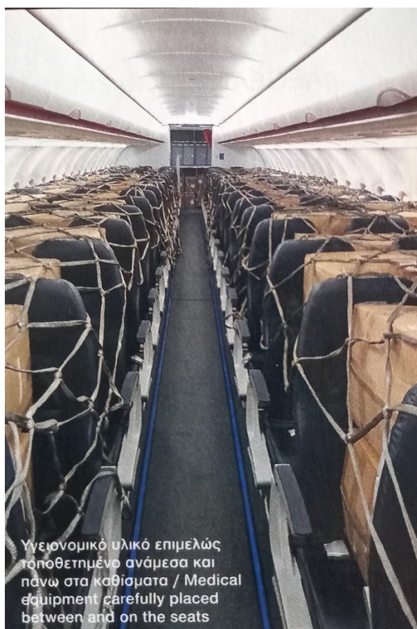
Εικόνα 11: Υγειονομικό υλικό φορτωμένο στην καμπίνα επιβατών (Φαρμάνης, 2020)
