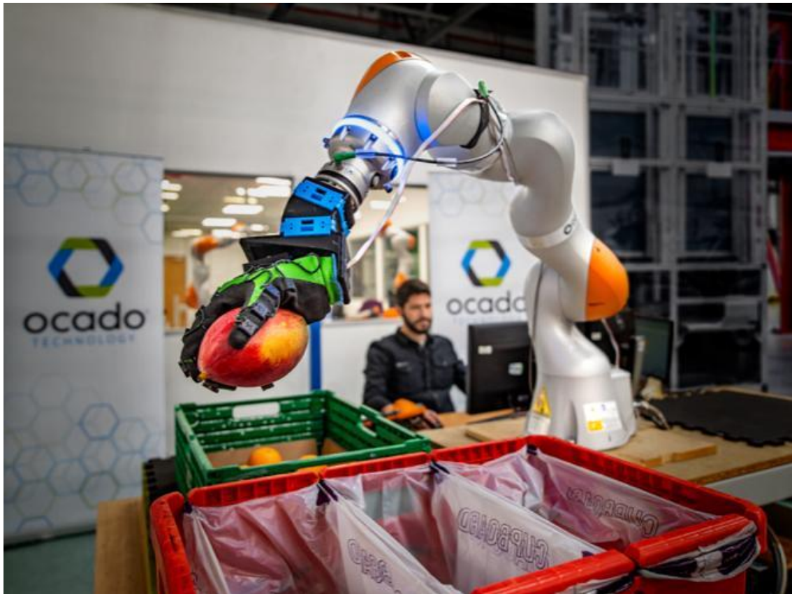
Εικόνα 18. Μαλακό ρομποτικό χέρι για τη διαλογή προϊόντων στις αποθήκες της Ocado
