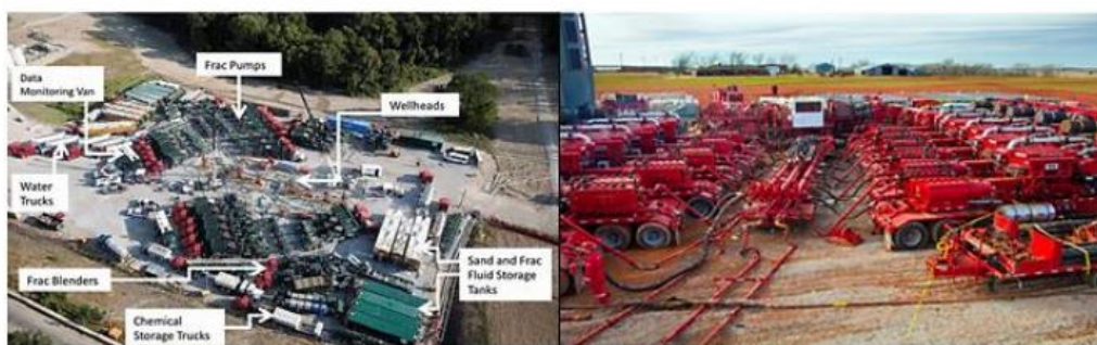
Εικόνα 21: Εγκαταστάσεις που απαιτούνται για υδραυλική ρηγμάτωση του πετρώματος (frac spread) http://info.drillinginfo.com/well-completion-well-stimulation/
