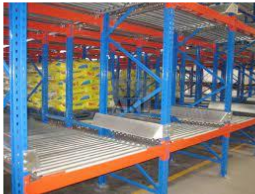
Εικόνα 5: Σύστημα ραφιών ροής (flow rack system)
