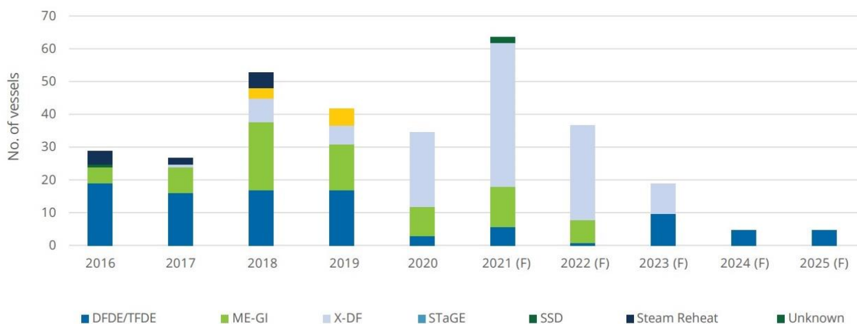
Πίνακας 28. Γράφημα: Συστήματα πρόωσης LNG πλοίων που παραδόθηκαν την περίοδο 2016-2020, καθώς και όσων θα παραδοθούν ως το 2025. Πηγή: IGU-World LNG Annual Report 2021, σελ. 61, World LNG Report 2021 | IGU
