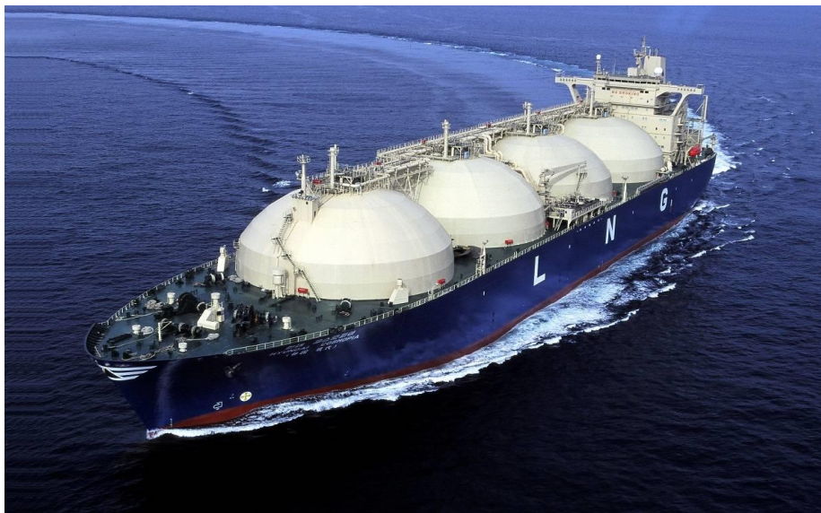
Εικόνα 21. Πλοίο μεταφοράς υγροποιημένου φυσικού αερίου με δεξαμενές τύπου MOSS Πηγή: Hyundai Heavy To Build Moss Type LNG Carriers (marinelink.com)
