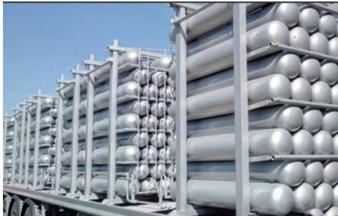
Εικόνα 4. Μεταφορά δοχείων CNG οδικώς. Πηγή: Η «ενεργειακή επανάσταση» του CNG | Η ΚΑΘΗΜΕΡΙΝΗ (kathimerini.gr)
