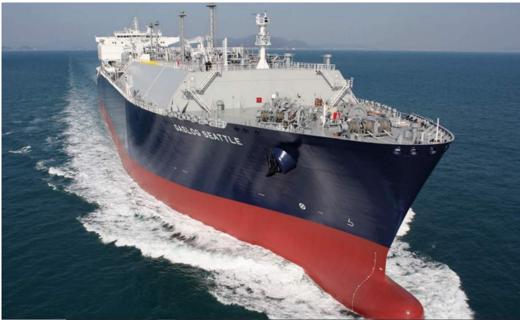
Εικόνα 26. Πλοίο μεταφοράς υγροποιημένου αερίου τύπου Membrane. Πηγή: SIGTTO lng-shipping-at-50compressed.pdf (sigtto.org)
