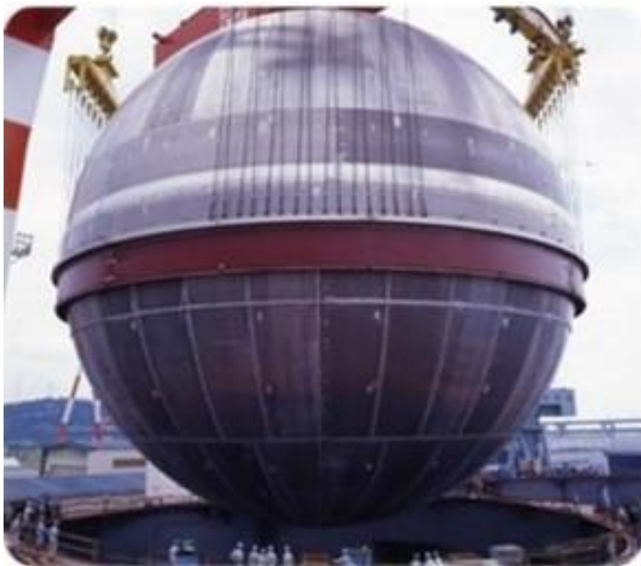
Εικόνα 28. Εισαγωγή σφαιρικής δεξαμενής MOSS σε πλοίο. Πηγή: ABS. Gas Carriers- Arrangements & Characteristics, σελ.35 Microsoft PowerPoint - Marine Chemist 22July14 EA with notes.pptx (wordpress.com)
