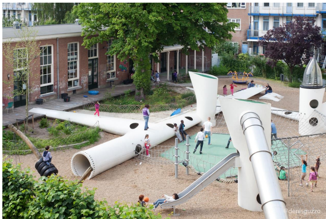
Εικόνα 9. Παιδική χαρά στο Ρότερνταμ που σχεδιάστηκε από το ολλανδικό αρχιτεκτονικό γραφείο Superuse επαναχρησιμοποιώντας πτερύγια παροπλισμένων ανεμογεννητριών. Πηγή: ( Blade Made | RE-USE.EU , no date), Ανακτήθηκε: 30/05/2022
