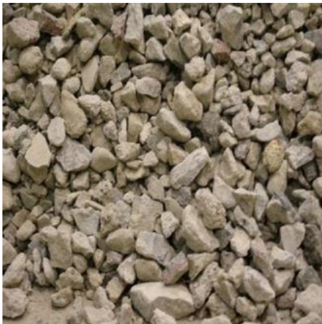
Εικόνα 8. Αδρανή από ανακυκλωμένο σκυρόδεμα. Πηγή: (McNeil and Kang, 2013), Ανακτήθηκε: 30/05/2022
