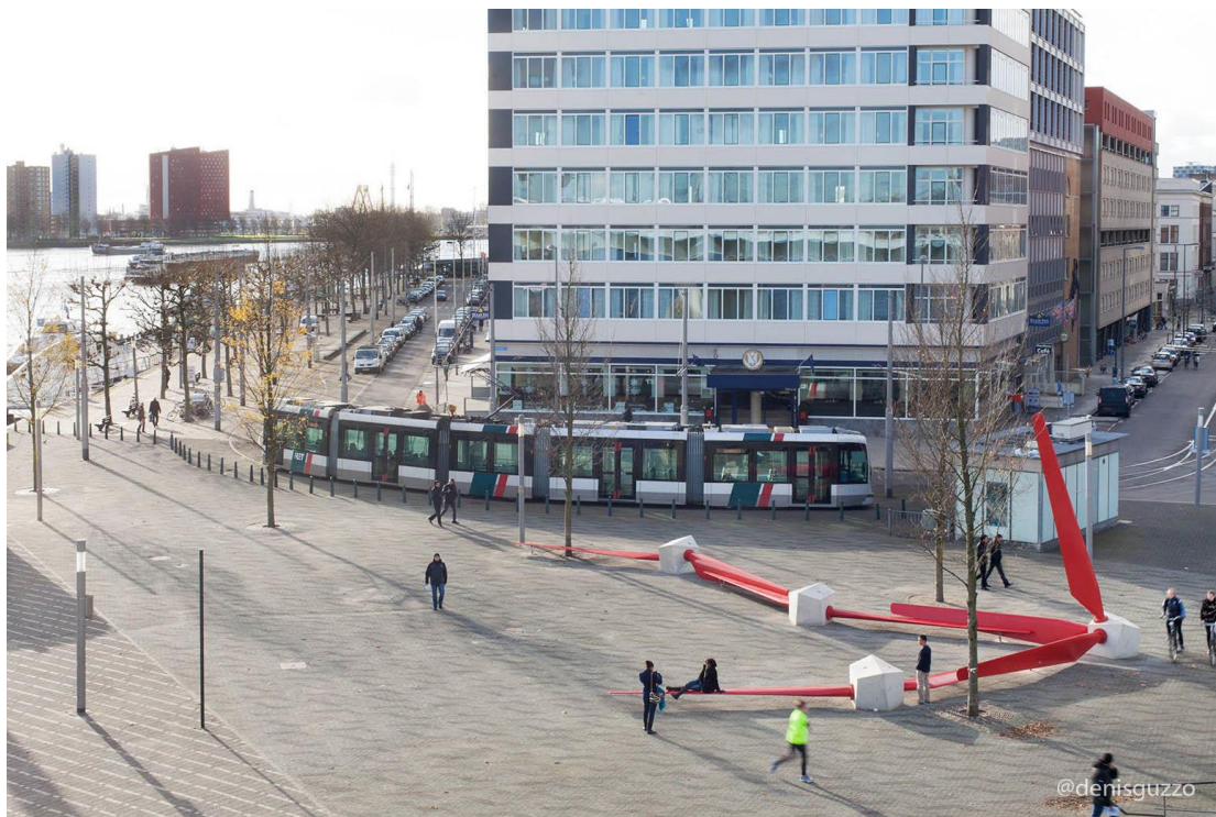
Εικόνα 10. Δημόσιος χώρος για καθήμενους στην πλατεία Willemsplein στο Ρότερνταμ επαναχρησιμοποιώντας πετύργια παροπλισμένων ανεμογεννητριών. Πηγή: (Blade Made | RE-USE.EU, no date), Ανακτήθηκε: 30/05/2022
