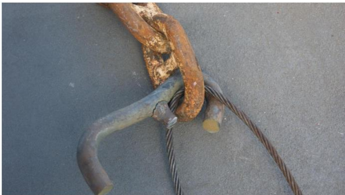
Εικόνα 16: Θραυσμένο αγκύλιο άμματος συστήματος αγκυροβολίας
