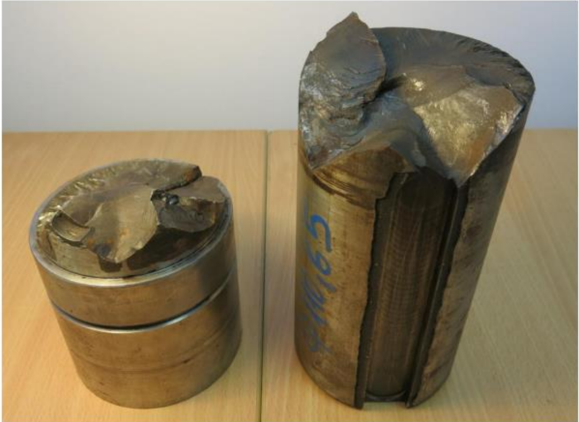
Εικόνα 25: Τα δύο τεμάχια από τον θραυσμένο άξονα της ηλεκτρομηχανής
