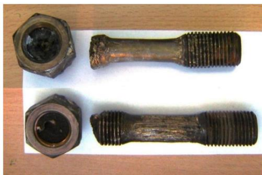
Εικόνα 22: Θραυσμένοι κοχλίες με τα περικόγλιά τους
