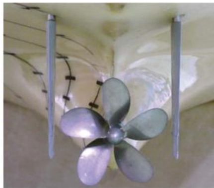
Εικόνα 45. Περίπτωση πηδαλίου τύπου 'Gate Rudder' (The Specialist Committee on Energy Saving Methods, 2017) (Sasaki N, 2016)
