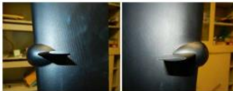
Εικόνα 46. Βολβός πηδαλίου με πτερύγιο (The Specialist Committee on Energy Saving Methods, 2017)
