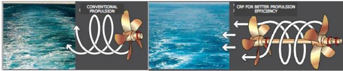
Εικόνα 27. Αριστερά, συμβατική προπέλα. Δεξιά, CRP (Rob Winkel, Arno van den Bos, Ulf Weddige - European Commission, 2015)
