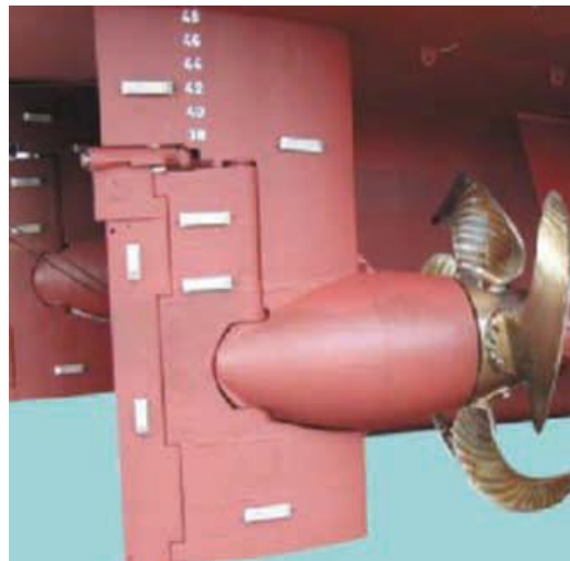
Εικόνα 20. Υψηλής αποδοτικότητας πηδάλιο της Wartsila (ABS, Ship Energy Efficiency Measures - Status and Guidance, 2021)
