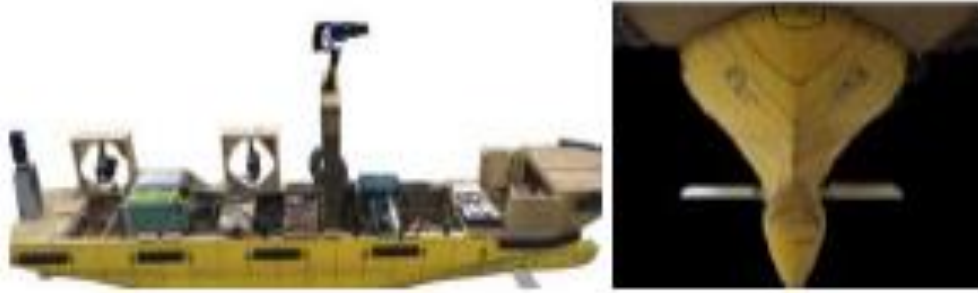
Εικόνα 48. Μοντέλο πλοίου με ενσωματωμένο περύγιο στην πλώρη (The Specialist Committee on Energy Saving Methods, 2021)
