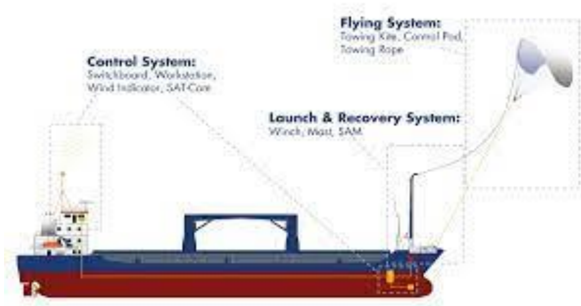
Εικόνα 38. Αετός έλξης (SkySails Propulsion, 2022)
