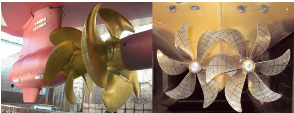
Εικόνα 28. Contra rotating και Overlapping propellers (Singh, 2018)
