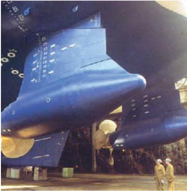
Εικόνα 23. Μεγάλος ωθητήρας τύπου κελύφους και τύπου αζιμούθιο (ABS, Ship Energy Efficiency Measures - Status and Guidance, 2021)
