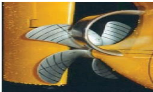
Εικόνα 15. Μοντέλο αγωγού Schneekluth (schneekluth.com, n.d.)
