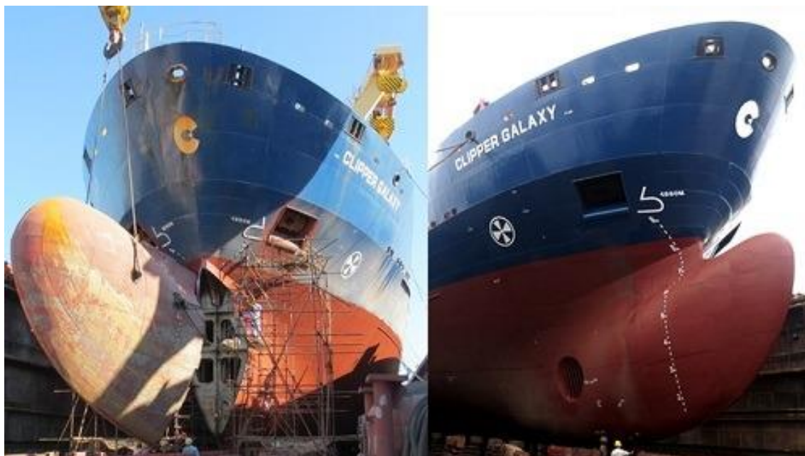
Εικόνα 12. Βολβός σχήματος αντίστροφου αχλαδιού (reverse pear-shaped) (Khasnabis, 2021)
