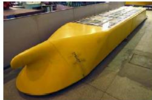
Εικόνα 49. Διαμόρφωση κάτω μέρους γάστρας για σύστημα κοιλότητας αέρα και φωτογραφία από μοντέλο δεξαμενόπλοιου (The Specialist Committee on Energy Saving Methods, 2021)
