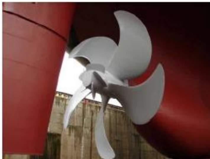
Εικόνα 26. Παράδειγμα PBCF (Rob Winkel, Arno van den Bos, Ulf Weddige - European Commission, 2015)
