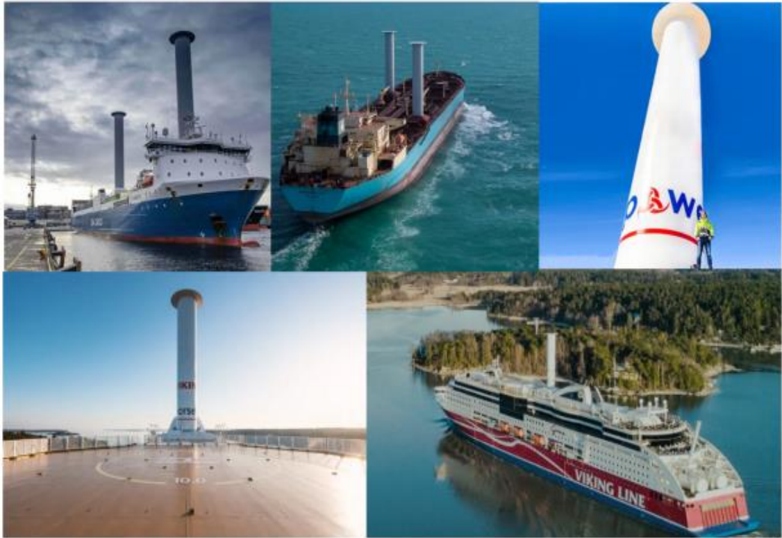
Εικόνα 40. Παραδείγματα εγκατεστημένων Ρότορων Flettner (Johanson, 2021)
