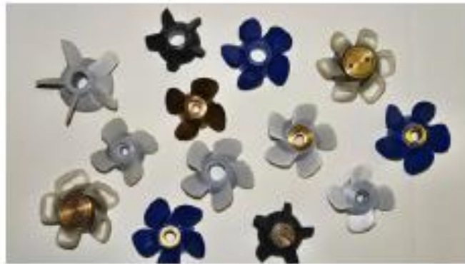
Εικόνα 44. Διάφοροι τύποι PBCF (The Specialist Committee on Energy Saving Methods, 2021)
