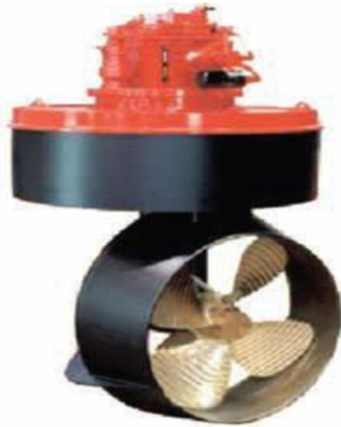
Εικόνα 23. Μεγάλος ωθητήρας τύπου κελύφους και τύπου αζιμούθιο (ABS, Ship Energy Efficiency Measures - Status and Guidance, 2021)
