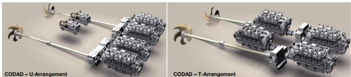
Εικόνα 4. Διάταξη συστήματος CODAD με δύο ζεύγη όμοιων πετρελαιοκινητήρων που κινούν δύο έλικες σε μορφή U-Arrangement και T-Arrangement. (Ohmayer, 2012)
