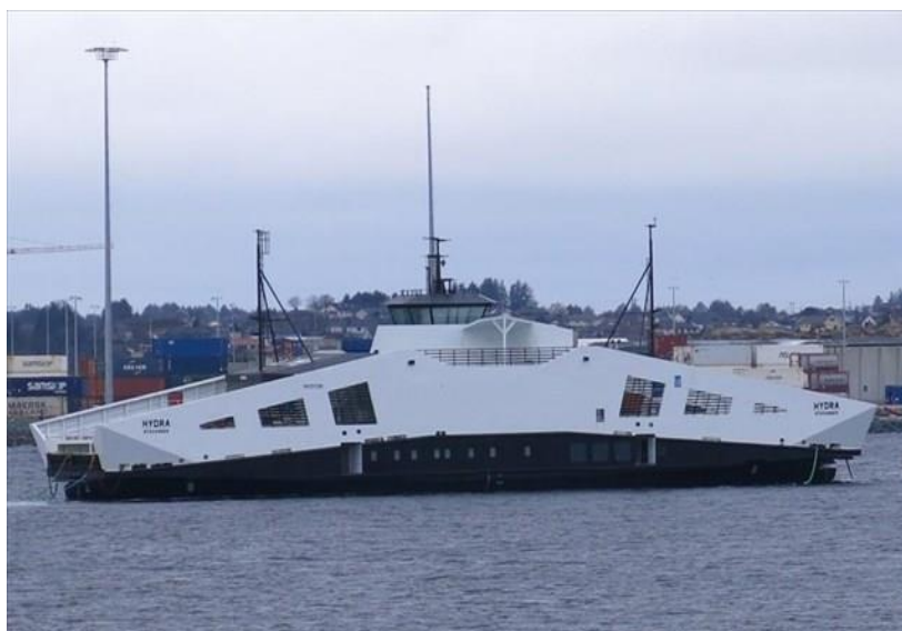
Εικόνα 18: Το Hydra, πλοίο της χρονιάς -Το πρώτο στο κόσμο με καύσιμο υγρό υδρογόνο Πηγή: https://www.naftemporiki.gr/finance/story/1773603/to-hydra-ploio-tis-xronias-to-protostokosmo-me-kausimo-ugro-udrogonono
