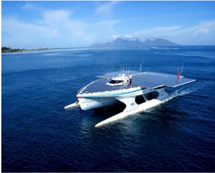
Εικόνα 15: MS Turanor PlanetSolar: το πρώτο ηλιακό πλοίο που έκανε τον γύρο του κόσμου
