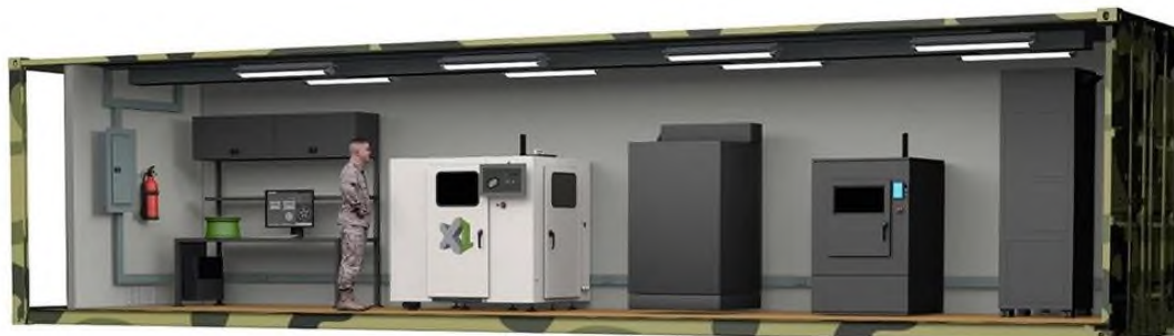
Εικόνα 32: Εκτέλεση της φορητής μονάδας παραγωγής πρόσθετων από την ExOne για το Υπουργείο Άμυνας των ΗΠΑ (Πηγή: ExOne, 2021)
