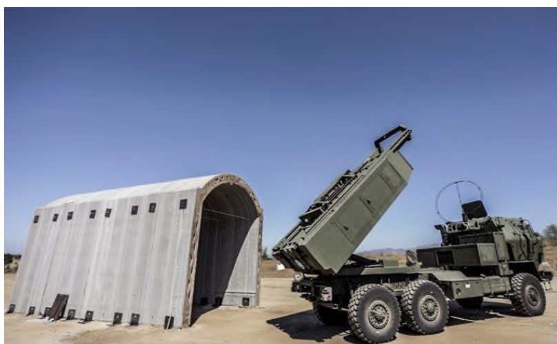
Εικόνα 31: Η τσιμεντένια κατασκευή για την προστασία του συστήματος πολλαπλής εκτόξευσης πυραύλων (Πηγή: USMC, 2020)
