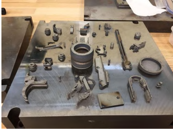
Εικόνα 23: Τα εκτυπωμένα μέρη του RAMBO, εκτός από την κάννη και το μηχανισμό όπλισης (Πηγή: U.S. Army Acquisition Support Center, 2017)
