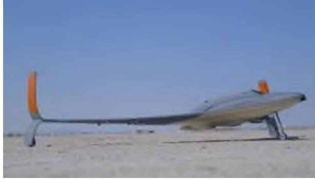
Εικόνα 26: Το πρώτο τριδιάστατο εκτυπωμένο UAV στον κόσμο (Πηγή: Stratasy, 2015)
