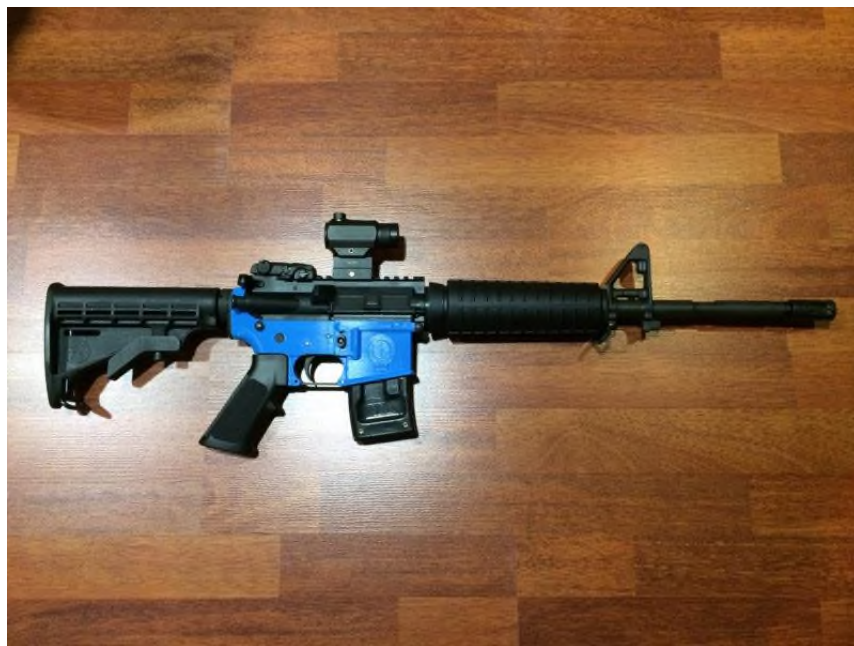
Εικόνα 20: Τυφέκιο AR-15 με τριδιάστατα τυπωμένα μέρη (Πηγή: 3D PrinterChat.com, 2020)
