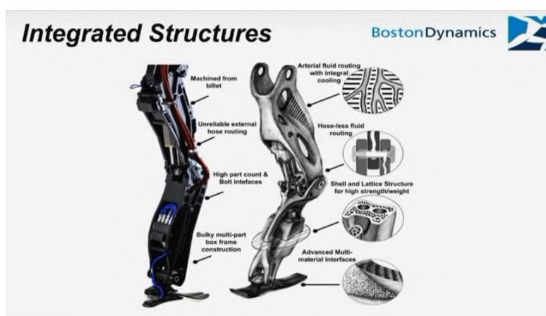
Εικόνα 28: Η κατασκευαστική δομή των ποδιών που εκτυπώνονται τριδιάστατα, για το ρομπότ Atlas (Πηγή: Boston Dynamics, 2016)
