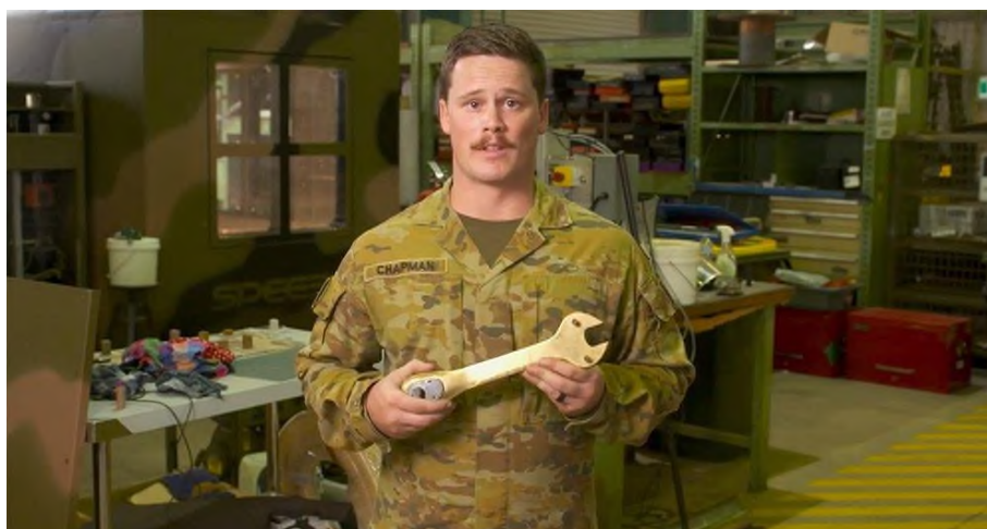
Εικόνα 16: Το 3D τυπωμένο με μέταλλο Gunner's Ratchet είναι ένα εργαλείο τόσο εξειδικευμένο που θα ήταν πολύ ακριβό να δημιουργηθεί χωρίς τριδιάστατη εκτύπωση (Πηγή, All3DP.Pro, 2021)
