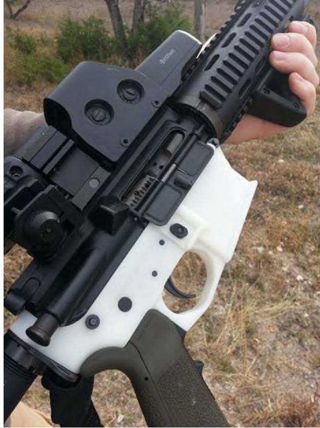
Εικόνα 19: Τυφέκιο AR-15 με τριδιάστατο εκτυπωμένο κάτω δέκτη (Πηγή: Dezeen, 2013)
