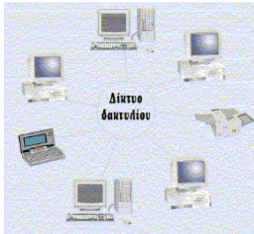
Σχήμα 4.6. Δίκτυο τοπολογίας δακτυλίου
