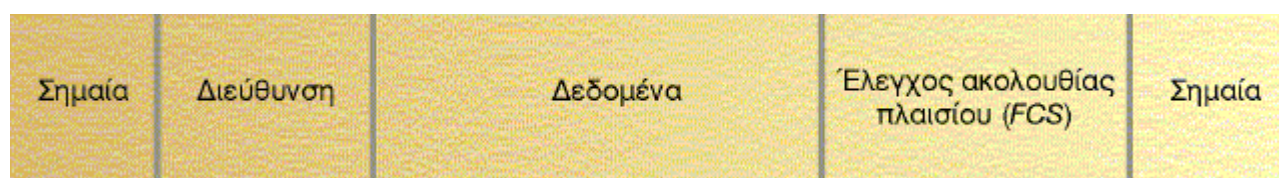
Σχήμα 4.75. Δομή πλαισίου μεταγωγής
