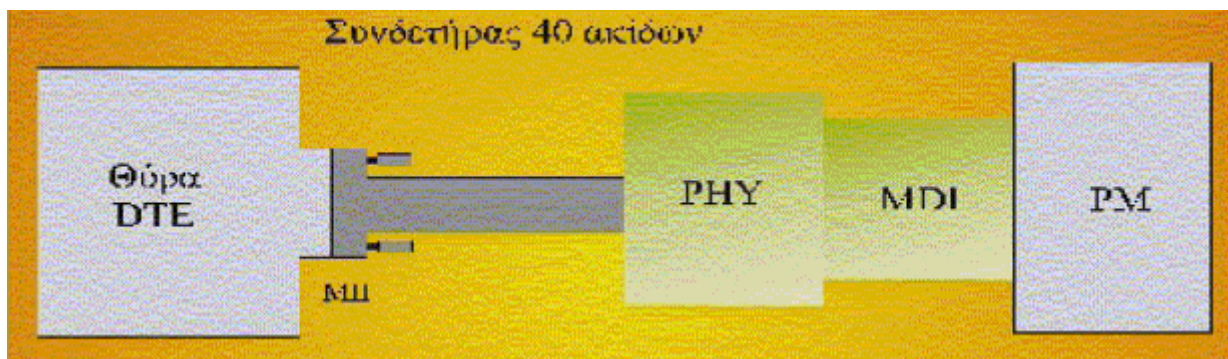
Σχήμα 4.58 Σχεδιάγραμμα μιας 100 Mbps δικτυακής σύνδεσης
