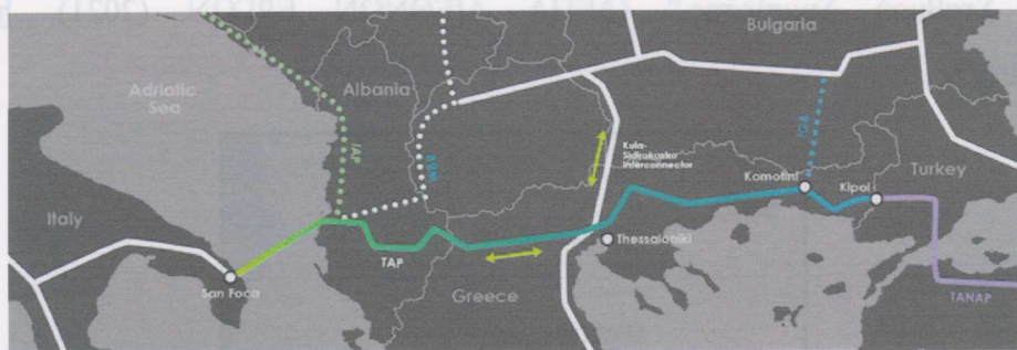
Εικόνα 7. Trans-Adriatic Pipeline (πηγή: TAP)
