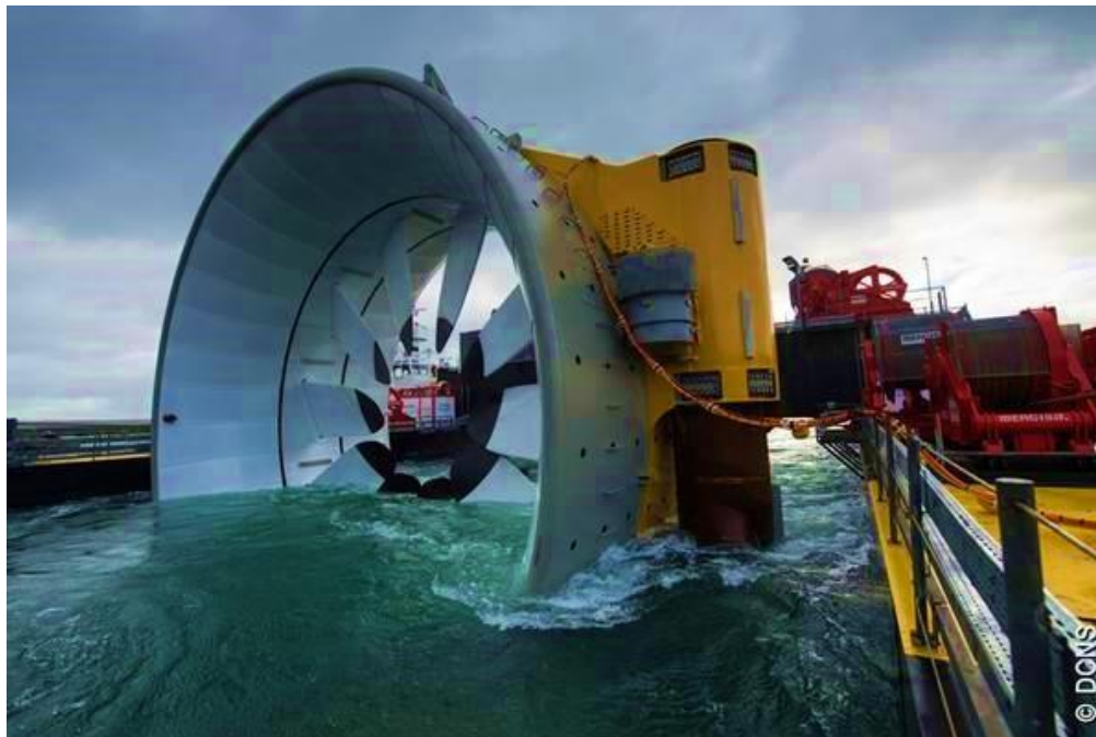
Εικόνα 1.11. Υδροστρόβιλος ΠΗΓΗ: ( https://www.thetimes.co.uk )
