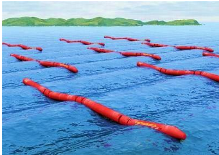
Εικόνα 1.9. Μηχανής συσσώρευσης και μετατροπής της κυματικής ενέργειας ΠΗΓΗ: ( http://www.ebg.edu.gt )
