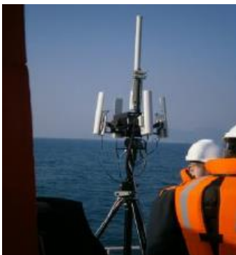
Σχήμα 38. Άποψη του συστήματος κεραιών του MariStation κατά τη διάρκεια μετρήσεων [11]
