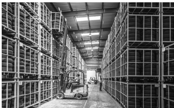
Εικόνα 6. Ηλεκτροκίνητο μηχάνημα αντίβαρου
