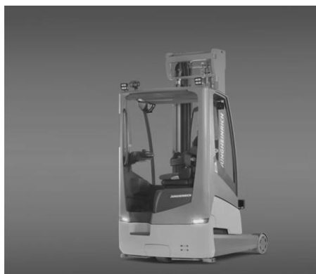
Εικόνα 7. Μηχάνημα Reach Truck
