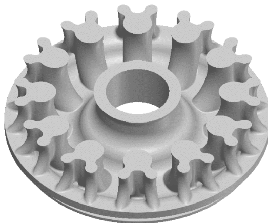
Εικόνα 28: Τομή βελτιστοποιημένου εμβόλου
