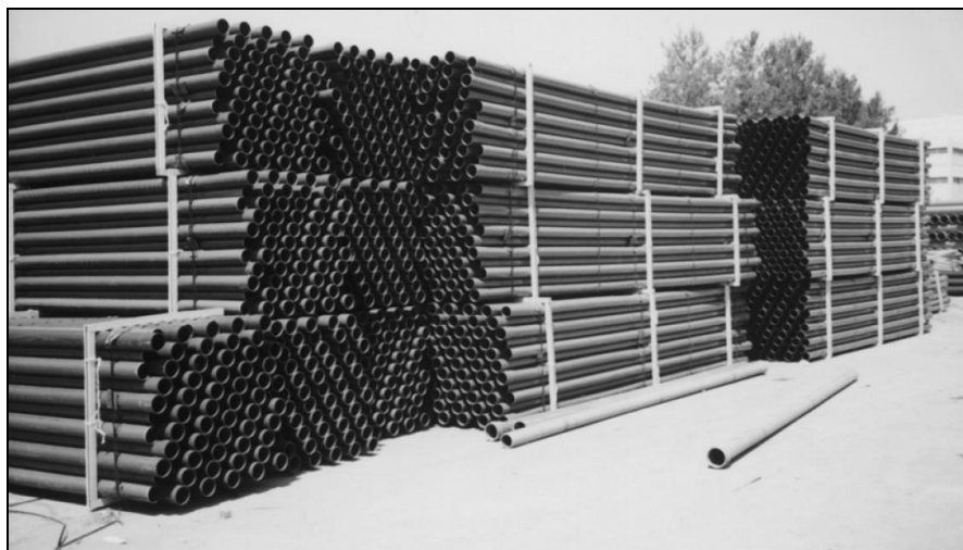
Εικόνα 7: Επάλληλα στρώματα για την αποθήκευση σωλήνων.
