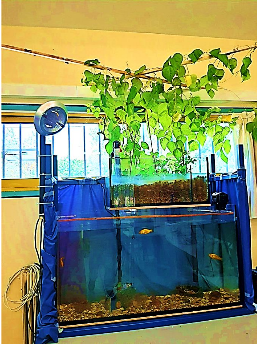
Σχήμα 12. Φωτογραφία του συστήματος ενυδρείοπονίας. Στο επάνω μέρος διακρίνονται υδρόφιλα φυτά τα οποία αρδεύονται από το νερό του ενυδρείου στο οποίο ζουν χρυσόψαρα.
