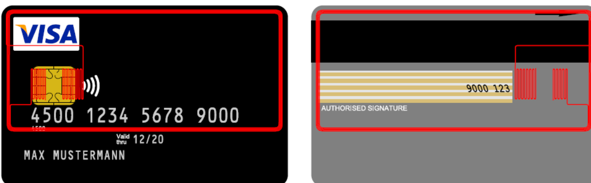
Σχήμα 2.5 Σχέδιο κεραίας σε κάρτα Visa της Austria Card [8]
