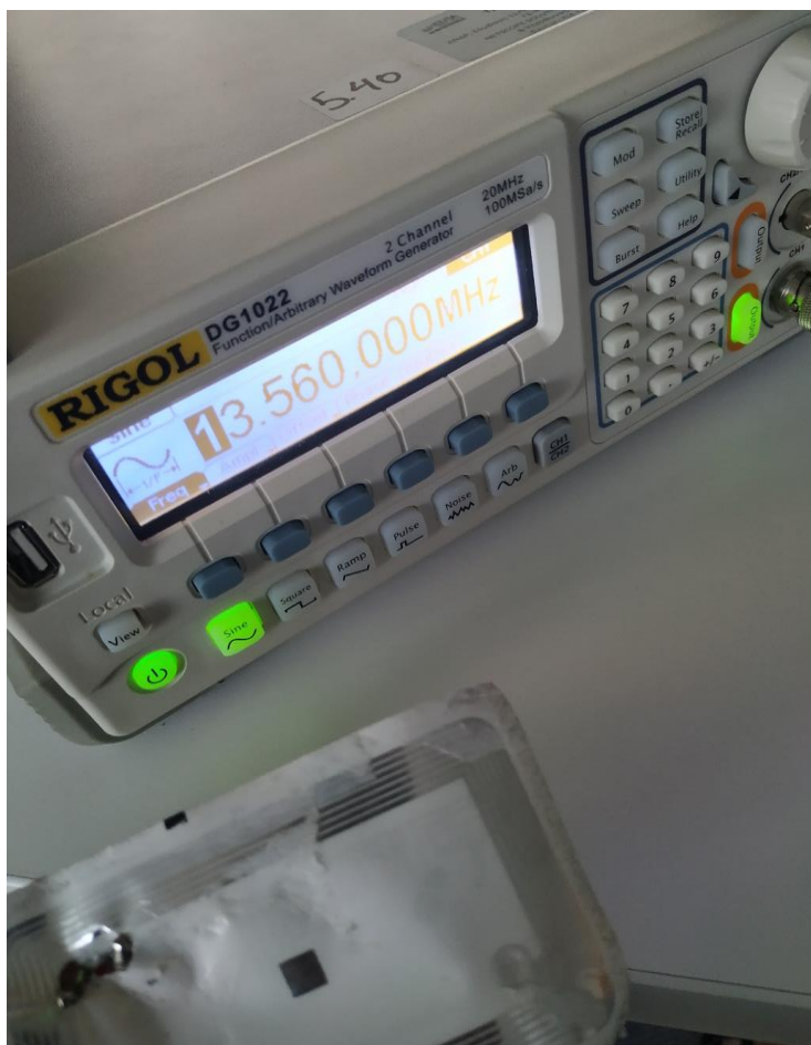
Σχήμα 6.12: Γεννήτρια και κεραία που χρησιμοποιήθηκαν για τη διεξαγωγή του πειράματος
