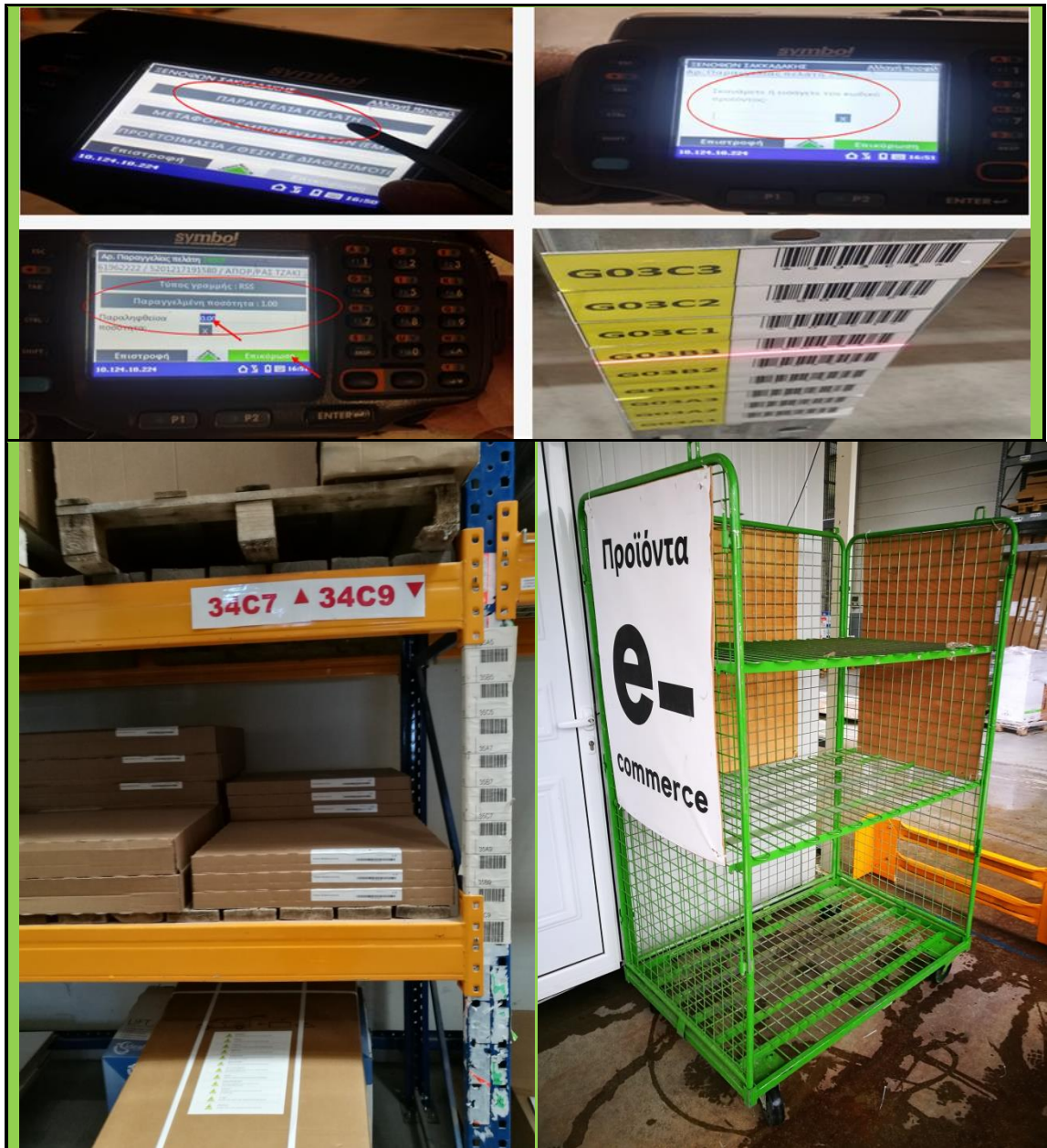
Εικόνα 5.14 : Χρήση RF τερματικού & roll cart για τη συλλογή παραγγελίας και χρήση barcode για τη κωδικοποίηση των θέσεων αποθήκευσης.
