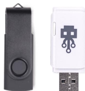
Εικόνα 13: Usb Killer v3 σε Anonymous και σε κανονική έκδοση
