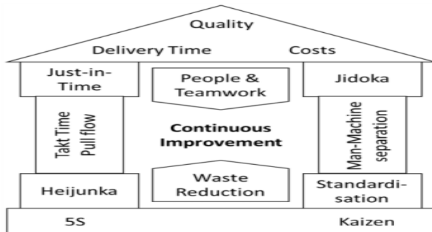
Εικόνα 3: Μοντέλο Ελάχιστης Δυνατής Παραγωγής (Lean Manufacturing) της Toyota (Wagner T. et al, 2017)
