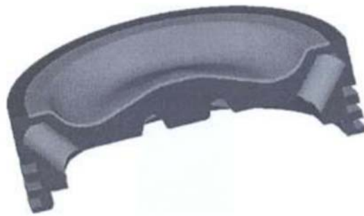
Εικόνα 11. 5. Ανοιχτός θάλαμος καύσης πετρελαιομηχανής πλοίου
