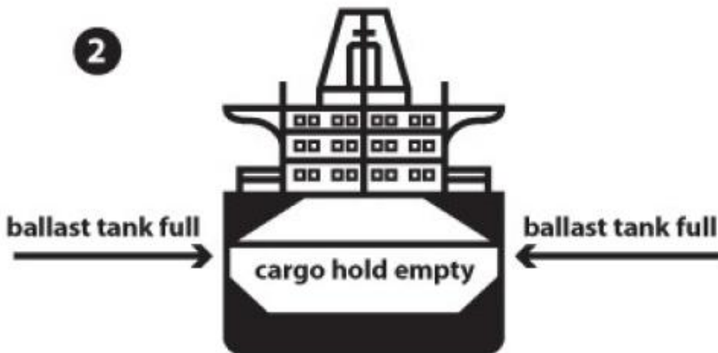
Εικόνα Νο.3: στο λιμάνι προορισμού όπου συμβαίνει η φόρτωση του πλοίου με το φορτίο λαμβάνει χώρα η απόρριψη του θαλάσσιου έρματος (αφερματισμός)
