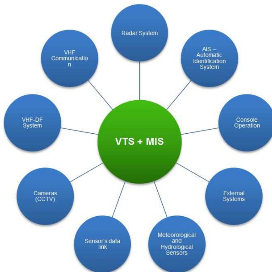
Εικόνα 4-1: Σχηματικό διάγραμμα των αισθητήρων και υποσυστημάτων του VTMIS.
