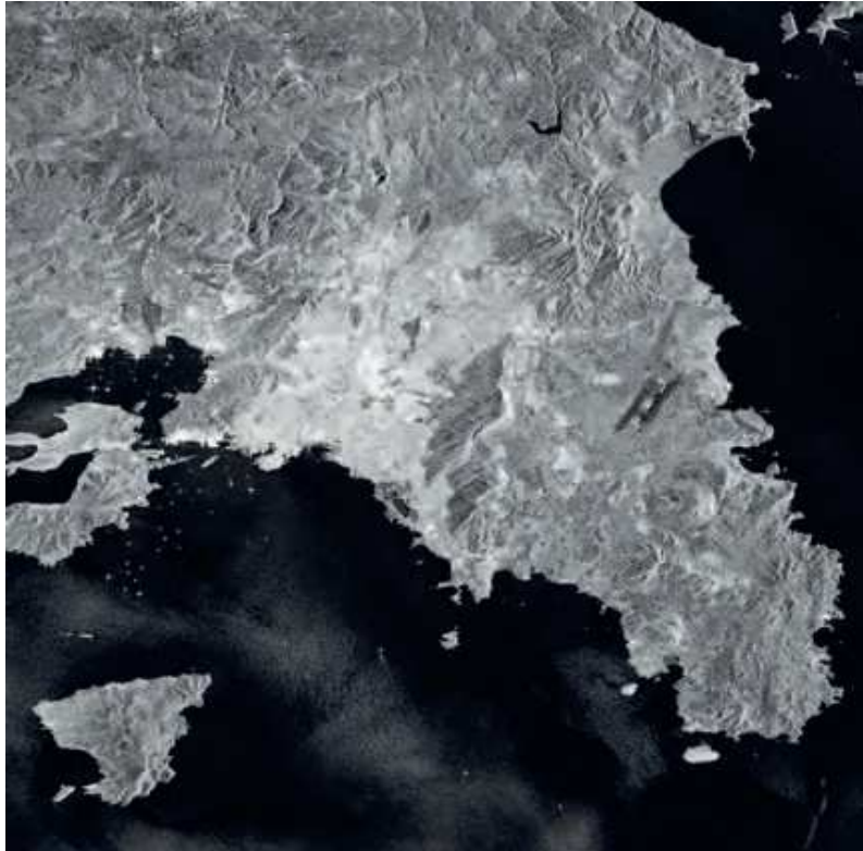
Εικόνα 3-4: Τμήμα δορυφορικής εικόνας από αισθητήρα SAR που απεικονίζει την Αττική, με την αρχική εικόνα να καλύπτει έκταση 250 x 250 χλμ. Πλοία με μήκος >100μ. φαίνονται ως φωτεινές κουκίδες στο αγκυροβόλιο της Σαλαμίνας.
