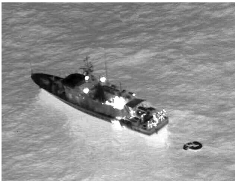
Εικόνα 4-6: Εικόνα προερχόμενη από ΗΟΣ που χρησιμοποιεί την τεχνολογία infrared (υπέρυθη ακτινοβολία). Τα σημεία του πλοίου με φωτίζουν έντονα είναι αυτά που έχουν μεγάλη θερμική υπογραφή: τα φώτα, το μηχανοστάσιο (στην αριστερή πλευρά ακριβώς πάνω από την ίσαλο), οι εξαγωγές των μηχανών, οι άνθρωποι στην πρύμνη.
