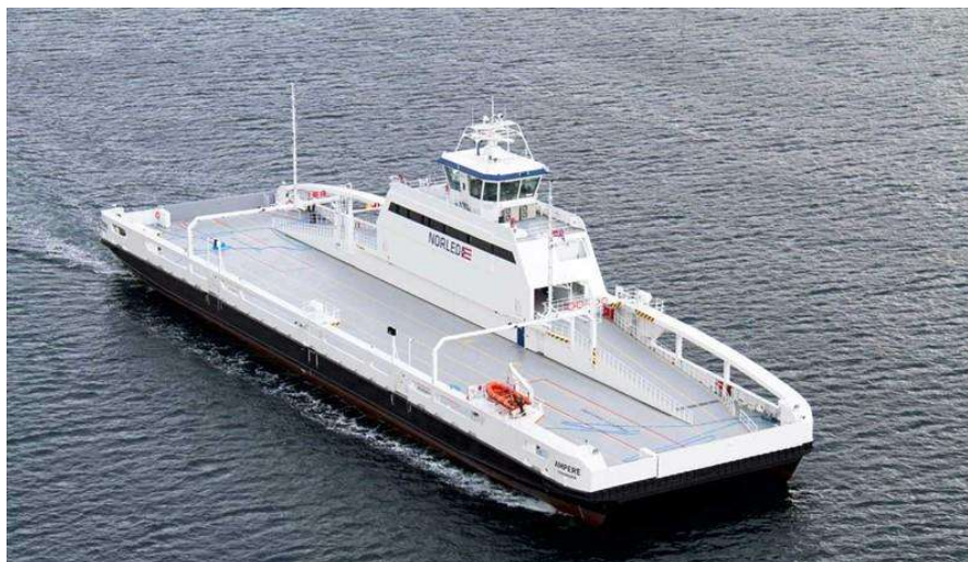
Εικόνα 1-4: Το Ro-Ro επιβατηγό και οχηματαγωγό πλοίο "Ampere", νορβηγικής σημαίας, είναι το πρώτο πλοίο παγκοσμίως, που λειτουργεί με μπαταρία.
