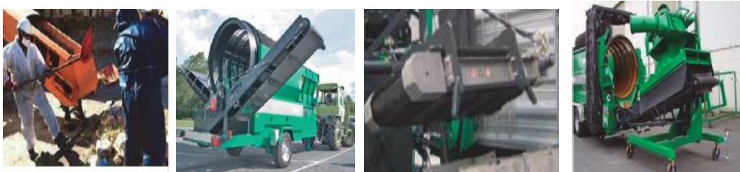
Εικόνα 5. 4: Διαχωρισμός προσμίξεων με χειροδιαλογή, κόσκινο, μαγνητικό διαχωριστή και αεροδιαχωριστή, από αριστερά προς τα δεξιά
