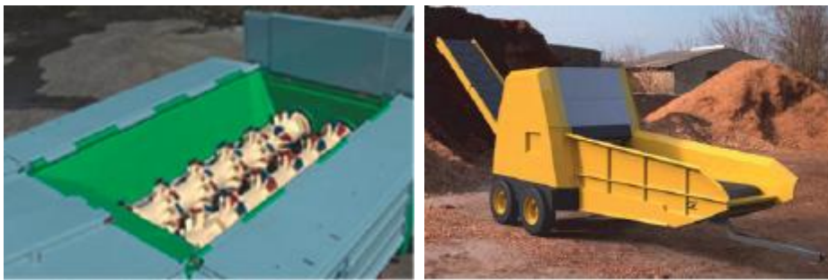
Εικόνα 5. 2: Λειοτεμαχιστής (shredder) και τεμαχιστής υψηλών στροφών (chipper, grinder), από αριστερά προς τα δεξιά
