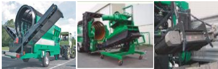
Εικόνα 5. 10: Ραφιναρία με κόσκινο, μαγνητικό διαχωριστή και αεροδιαχωριστή, από αριστερά προς τα δεξιά
