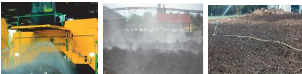
Εικόνα 5. 8: Διαβροχή με αναστροφέα, σταθερή και κινητή διάταξη εκνέφωσης, από αριστερά προς τα δεξιά.
