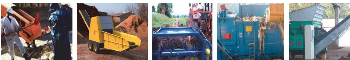
Εικόνα 5. 3: Τεχνικές διάνοιξης σάκων με χειροδιαλογή, με τεμαχιστή, με αναστροφέα, με σχίστη σάκων και με αναμίκτη, από αριστερά προς τα δεξιά
