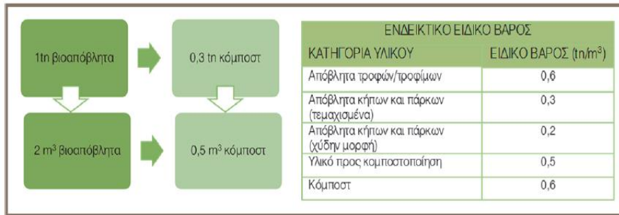
Πίνακας 5. 1: Τυπικό διάγραμμα ροής- ισοζύγιο μάζας μονάδας κομποστοποίησης (πηγή: J.Ottow, 1997)
