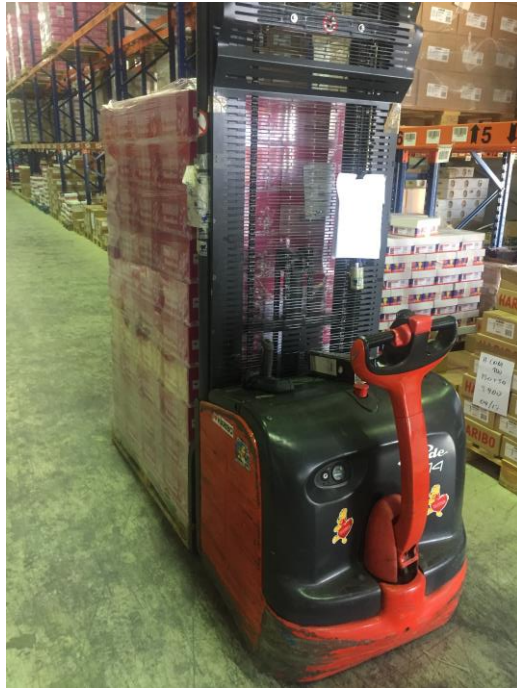
Εικόνα 5: Διαδικασία picking παλέτας με τη χρήση ηλεκτρικού περονοφόρου
