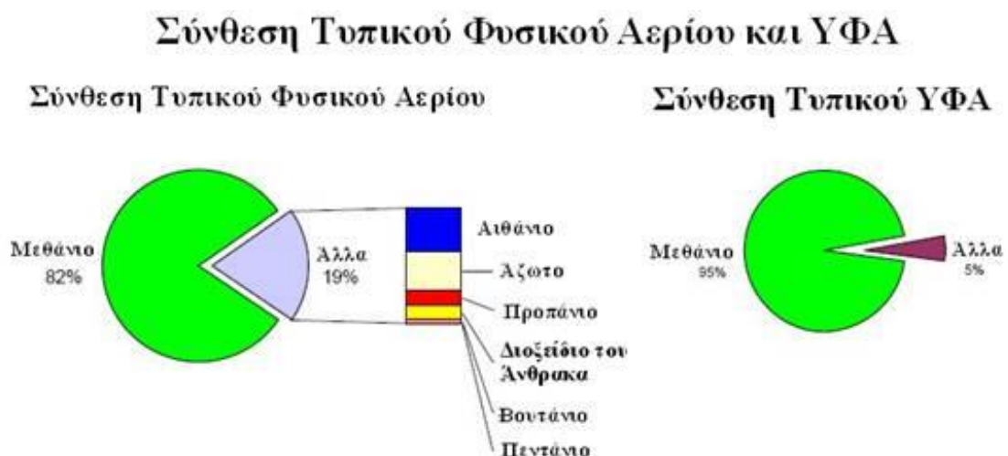
Εικόνα 3: Σύνθεση Τυπικού Φυσικού Αερίου και ΥΦΑ
