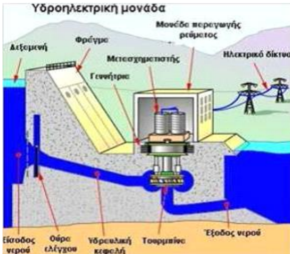
Σχήμα 3.8. Σκαρίφημα μιας υδροηλεκτρικής μονάδας με δεξαμενή
