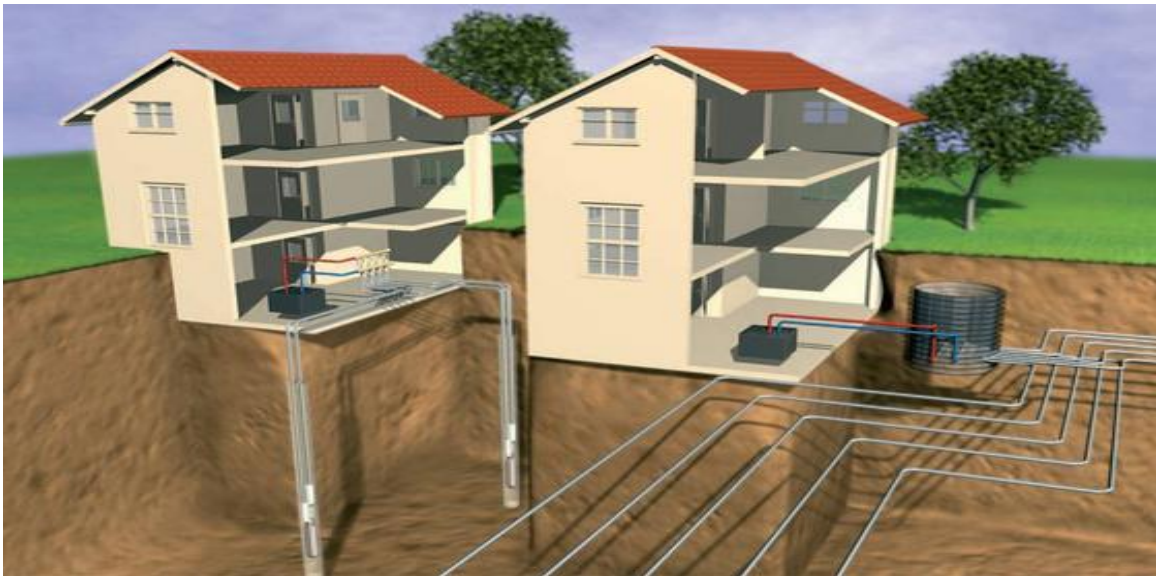
Σχήμα 3.9. Θέρμανση με χρήση γεωθερμικών αντλιών θερμότητας
