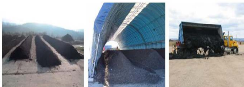
Εικόνα 2-12: Εγκαταστάσεις κομποστοποίησης σε στατικούς σωρούς (Πηγή: Κανακόπουλος, 2011)
